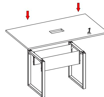
2.2 Encaixe o tampo e trave o tampo com os parafusos M6X45 D
