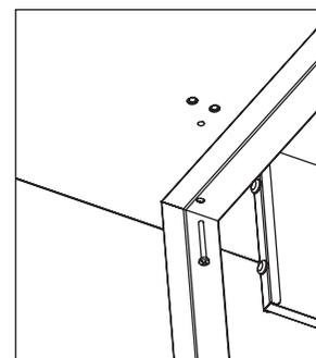
2.2 Posicione os parafusos M6x45 D nos pés metálicos conforme o detalhe
